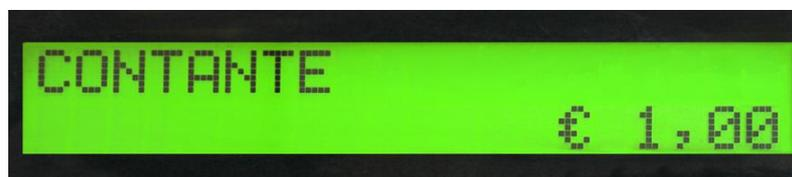
L'apparecchio è dotato di due display retroilluminati ognuno composto da 2 righe di 20 caratteri di tipo LCD alfanumerico, uno inclinabile dedicato all'Operatore e l'altro, per il Cliente, su torretta sollevabile ed orientabile.
